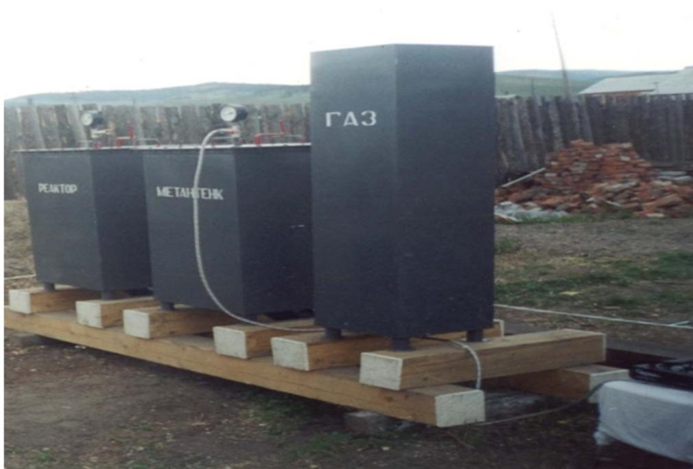
При проведении производственной проверки биогазовой установки доза загрузки (Д) метантенка составляла 15,0% от объема сбрасываемого сырья с периодичностью загрузки 2 суток, температура технологического процесса + 37°C, влажность (W) 95%, зольность субстрата ( $A_c$ ) 2,26%.
