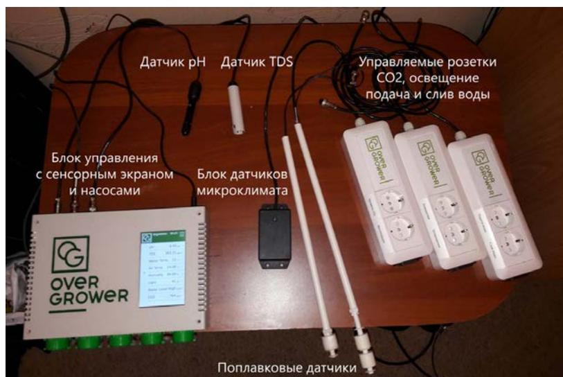
Рисунок 2. Элементы системы контроля и управления условиями выращивания
