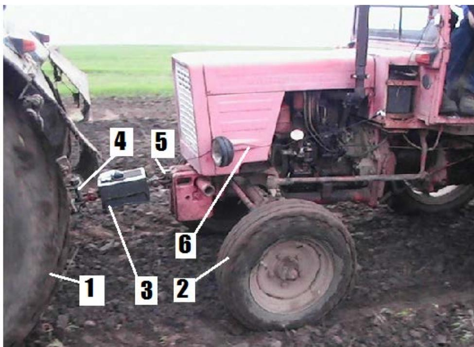
Рисунок 1. Настройка измерительного комплекса для измерения тягового сопротивления пахотного агрегата Т-25А+ПН 3-23(без смещения влево буксировщика): 1-буксировщик (МТЗ-82); 2- исследуемый агрегат; 3- измерительный комплекс; 4- прицепная серьга буксировщика; 5- буксировочная вилка трактора; 6- кабель от измерительного комплекса к портативному ПК
