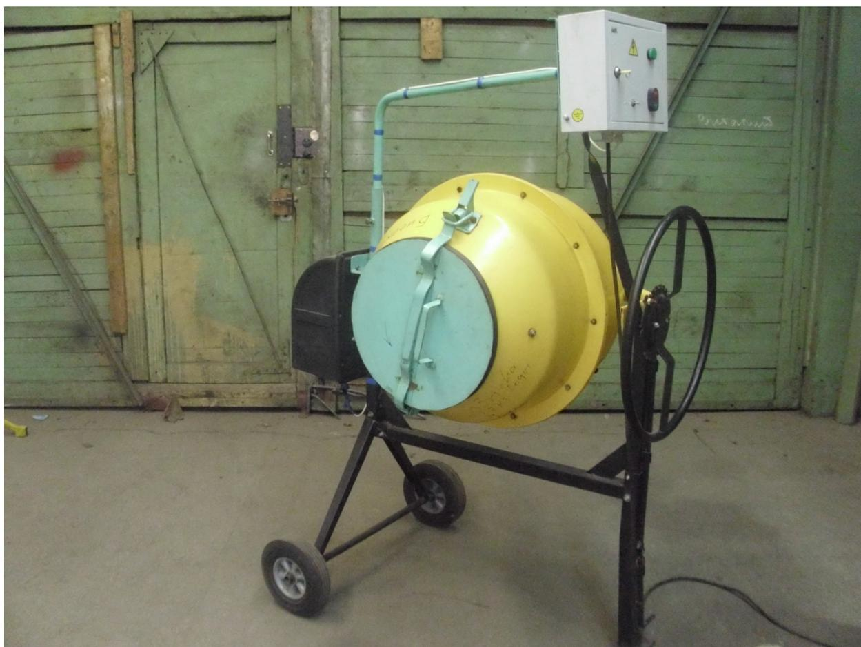
Рис. Биоактиватор зерна с пультом управления
