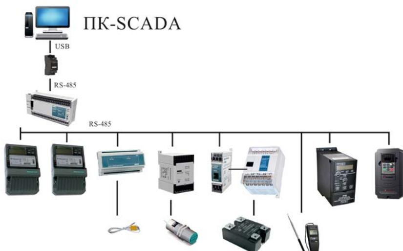
Рисунок 1 – Структурная схема системы контроля лабораторного оборудования и параметров процесса сушки зерна
